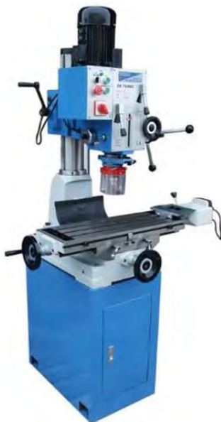
Bohr- und Fräsmaschine
